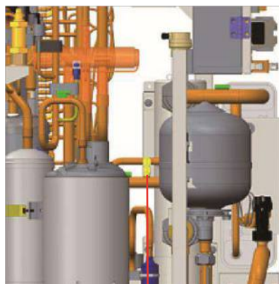
Válvula de carregamento 1
