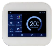
NPM/A1 - Comando Parede Digital 230V + 3 velocidades + 2/4 tubos. Ecrã cores sensível ao toque TFT 3,5. Contacto seco para contacto de janela. Entrada para sonda de água. Programação semanal + Wi-Fi. (necessita de caixa de aparelhagem Ø60x40mm não incluída) Compatível com a caixa de aparelhagem quadrada 761080 75x75x42mm não incluída
