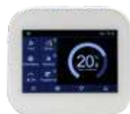
NPM/A1 -010 - Comando Parede Digital Brushless 230V + 0-10 V + 2/4 tubos. Ecrã cores sensível ao toque TFT 3,5. Contacto seco para contacto de janela. Entrada para sonda de água. Programação semanal + Wi-Fi. (necessita de caixa de aparelhagem Ø60x40mm não incluída) Compatível com a caixa de aparelhagem quadrada 761080 75x75x42mm não incluída
