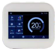
NPM/A1 - Comando Parede Digital 230V + 3 velocidades + 2/4 tubos. Ecrã cores sensível ao toque TFT 3,5. Contacto seco para contacto de janela. Entrada para sonda de água. Programação semanal + Wi-Fi. (necessita de caixa de aparelhagem Ø60x40mm não incluída)
